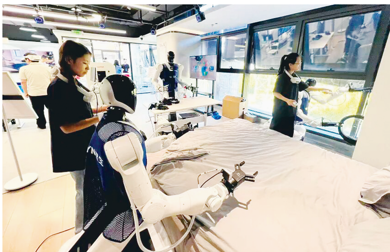
居家场景下,工作人员正在对机器人进行遥控操作动作训练。
