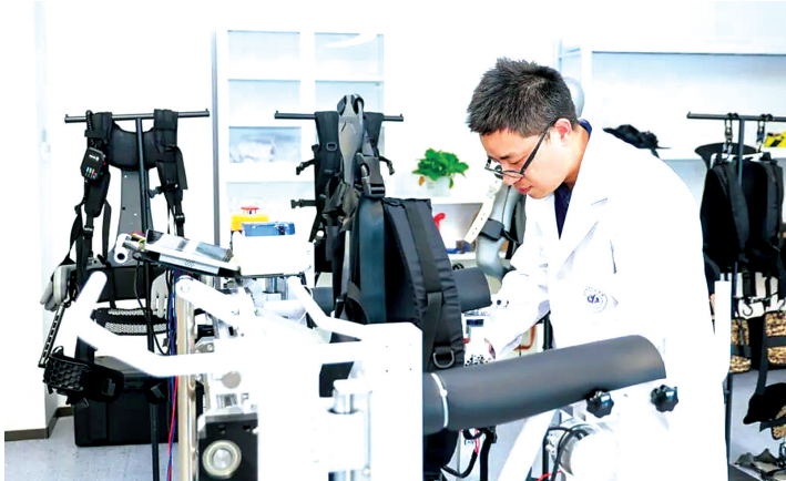
北京航空航天大学杭州创新研究院研究员调试外骨骼机器人设备 杭州高新区(滨江)供图
