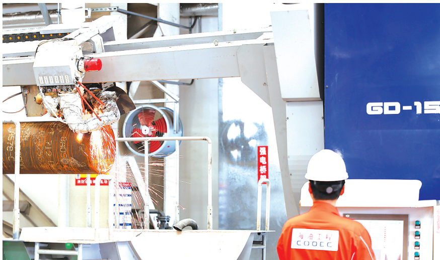
2026年6月16日,工作人员在海油工程天津智能制造基地监测钢管全自动加工设备运行情况。 新华社记者 李然/摄
