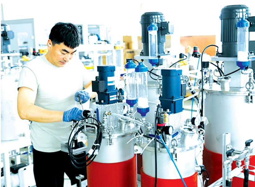
龙升精密工作人员正在组装风电碳纤维板材用灌胶点胶机。威海火炬高新区供图
