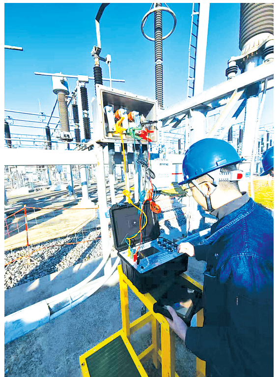
左图:HL-F2型高压电缆接地系统状态检测仪
