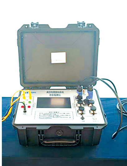
左图:HL-F2型高压电缆接地系统状态检测仪
