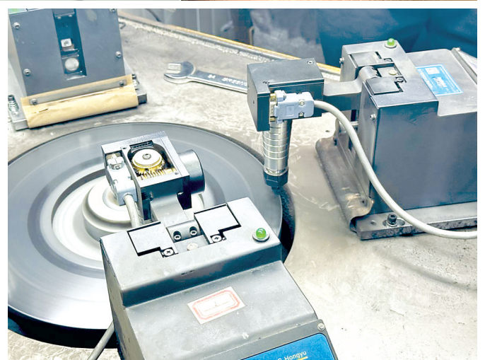
下图：抛光机器正在对金刚石进行抛光。
