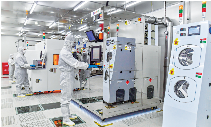
左图:研发人员在陕西光电子先导院“6英寸化合物光电芯片平台”键合区作业。
