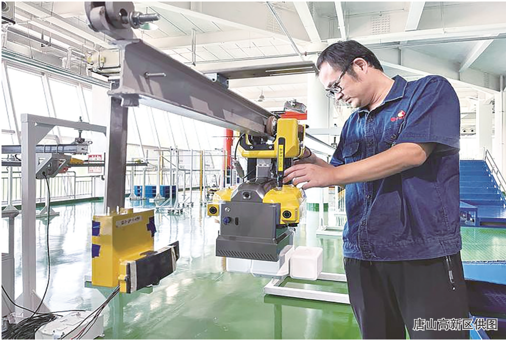
中信重工开诚智能装备有限公司工程师测试矿用轨道巡检机器人。
