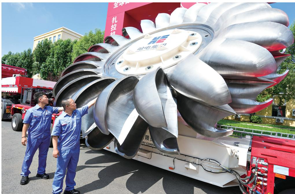
世界首台单机500兆瓦扎拉水电站冲击式水轮发电机组转轮在哈电集团哈尔滨电机厂有限责任公司自主研制成功,并于7月2日发运,标志着我国在高水头、大容量冲击式水轮机组核心装备领域实现历史性突破。该自主化研制的冲击式转轮由21个精密水斗构成,外径达6.23米、整轮厚度1.34米、重量约80吨,是国家“藏电外送”骨干电站扎拉水电站水轮发电机组的“心脏”,为发电机发出500兆瓦额定功率提供源动力。图为第一线焊接人员介绍转轮的焊接位置。
