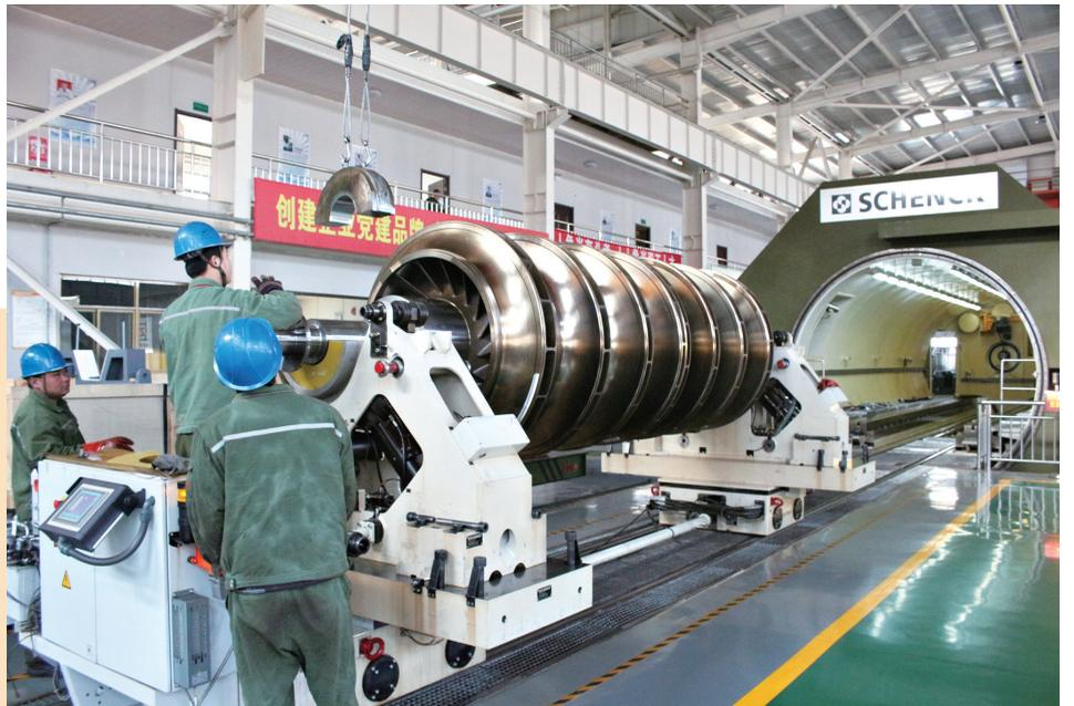
美国埃理奥特离心式压缩机转子高速动平衡试验
