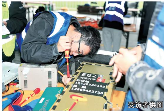
左图:2024中国数字汽车大赛创新组“未来之路”团队队长陈思阳在为已经做完检查的电池箱采取固定与防水措施。
