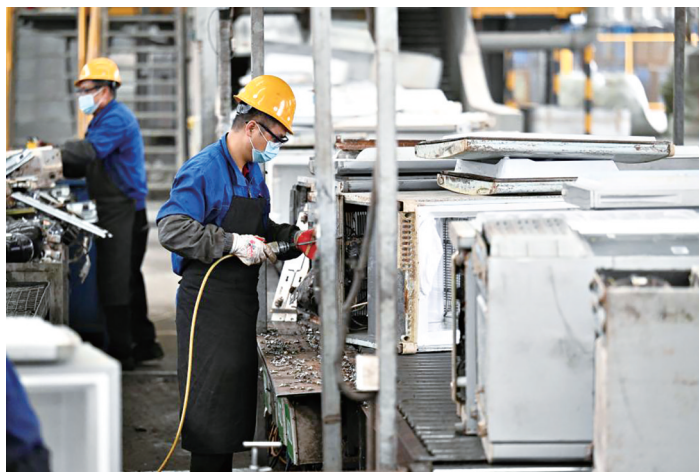
天津一家家电拆解企业的工作人员在冰箱拆解线拆解废旧冰箱。
