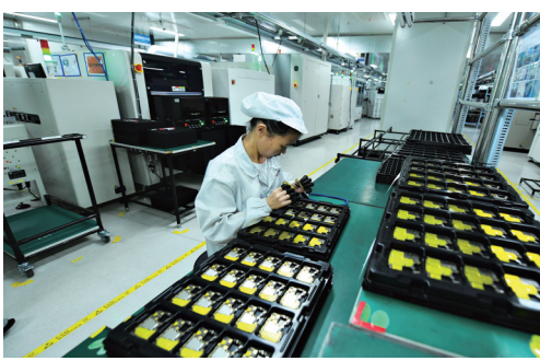
在龙旗 SMT 生产车间,生产线工人正在对产品进行外观检查。
