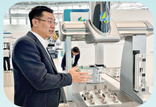
海克斯康推出的矩阵式叶片测量方案,精度达0.3微米。
