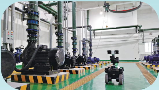
海拓智能研发的轮式巡检机器人正在化工企业车间进行安全检查。
