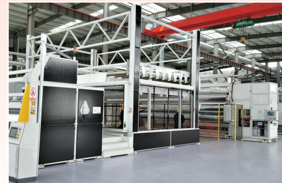
高强粗旦聚丙烯 (PP) 长丝纺粘针刺非织造无纺布土工布生产线
