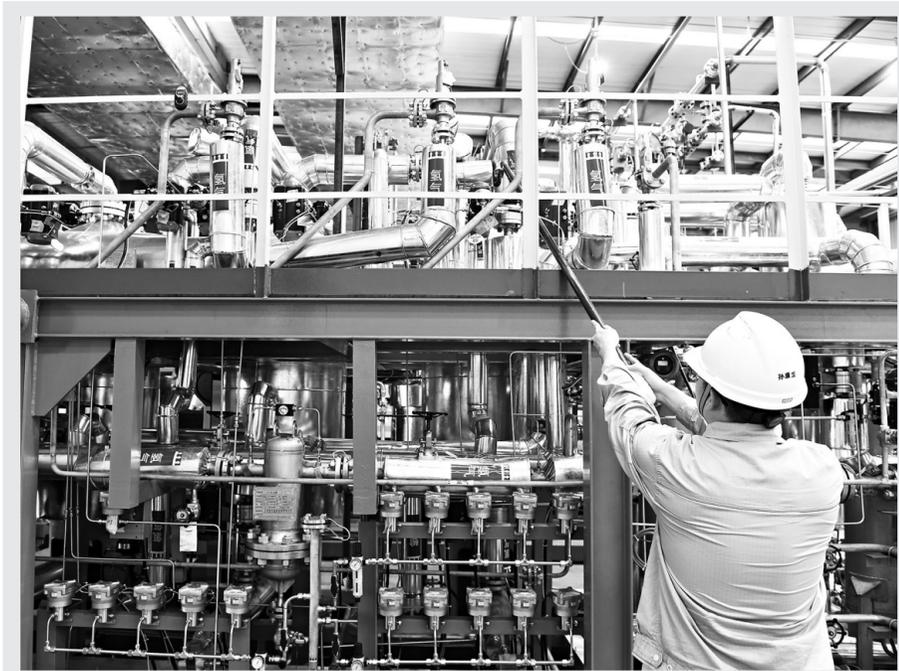
近年来,东北地区围绕资源优势加速布局清洁能源产业,持续加快风能、光能、氢能等新能源产业建设,为全面振兴提供新动能。图为8月12日在长春绿动氢能科技有限公司,工人正在检查制氢设备的密封性。
