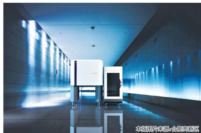
国仪量子——量子钻石原子力显微镜
