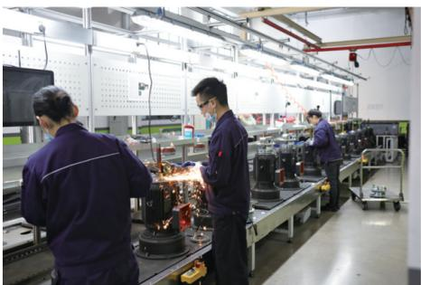
常德苏通力原工程机械有限公司生产线上，工人正在打磨电机部件。
