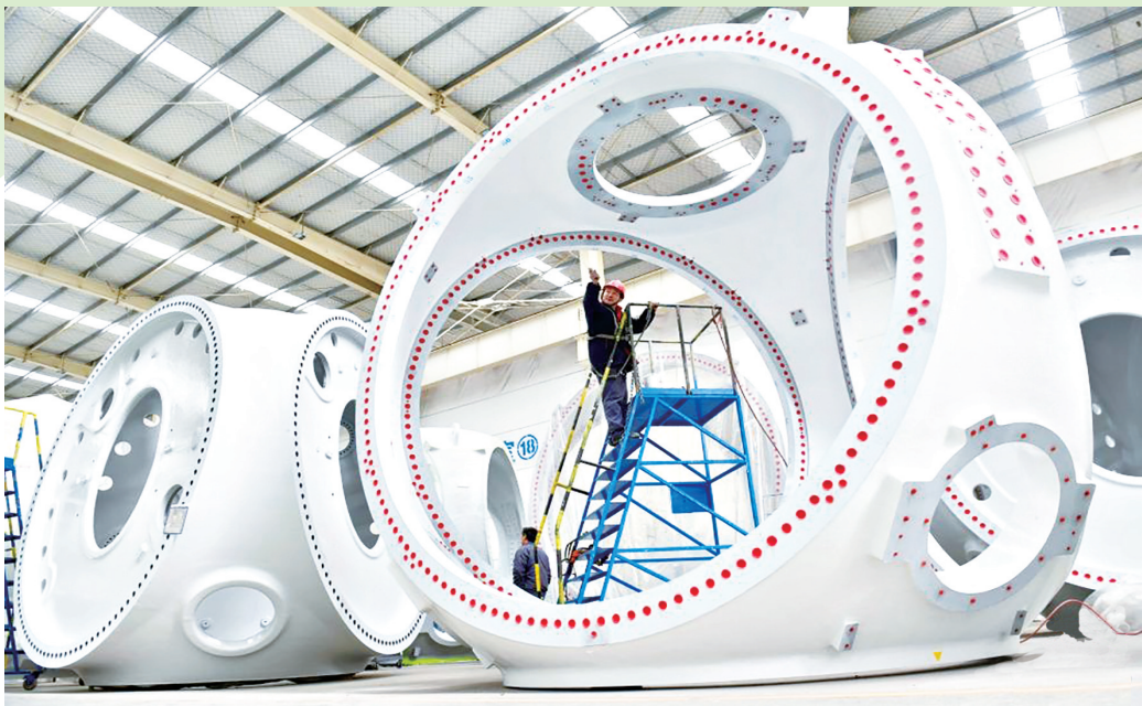
山东省滨州市聚焦2024年高质量发展目标，聚力实施工业企业产值倍增专项行动，锚定传统产业高端化、新兴产业规模化、特色产业园区化、未来产业协同化发展方向，开足马力忙生产、赶订单，奋力冲刺首季“开门红”。图为3月1日，在滨州市惠民经济开发区风电装备制造产业园涂装车间，工人在涂装风电轮毂。
