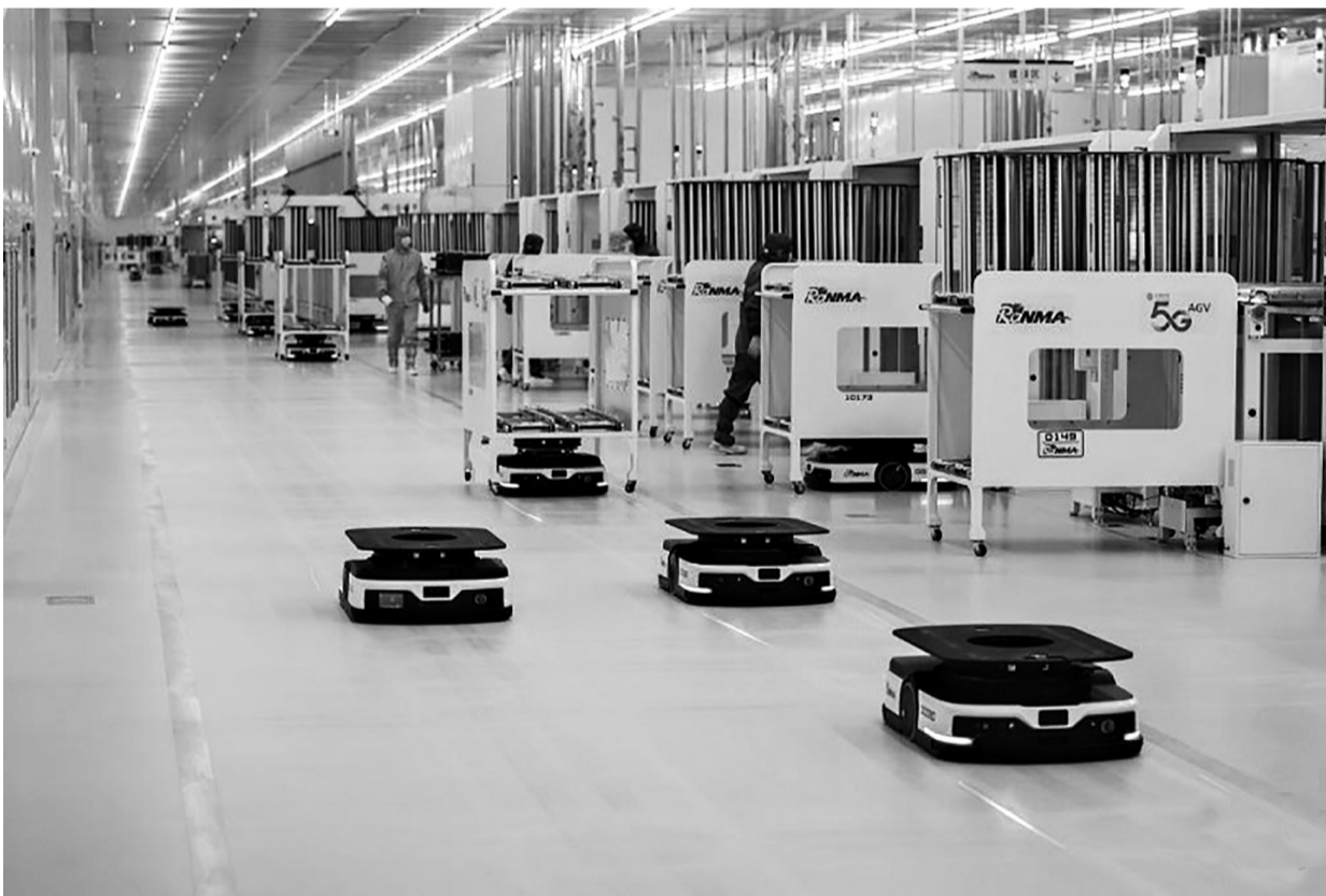
2月19日,在位于浙江省金华市金义新区的润马光能科技(金华)有限公司8GW高效光伏TOPCon电池项目智能车间,AGV智能机器人在自动运行中。据了解,该企业当前订单交付已排到2个月。新华社记者 徐昱/摄
