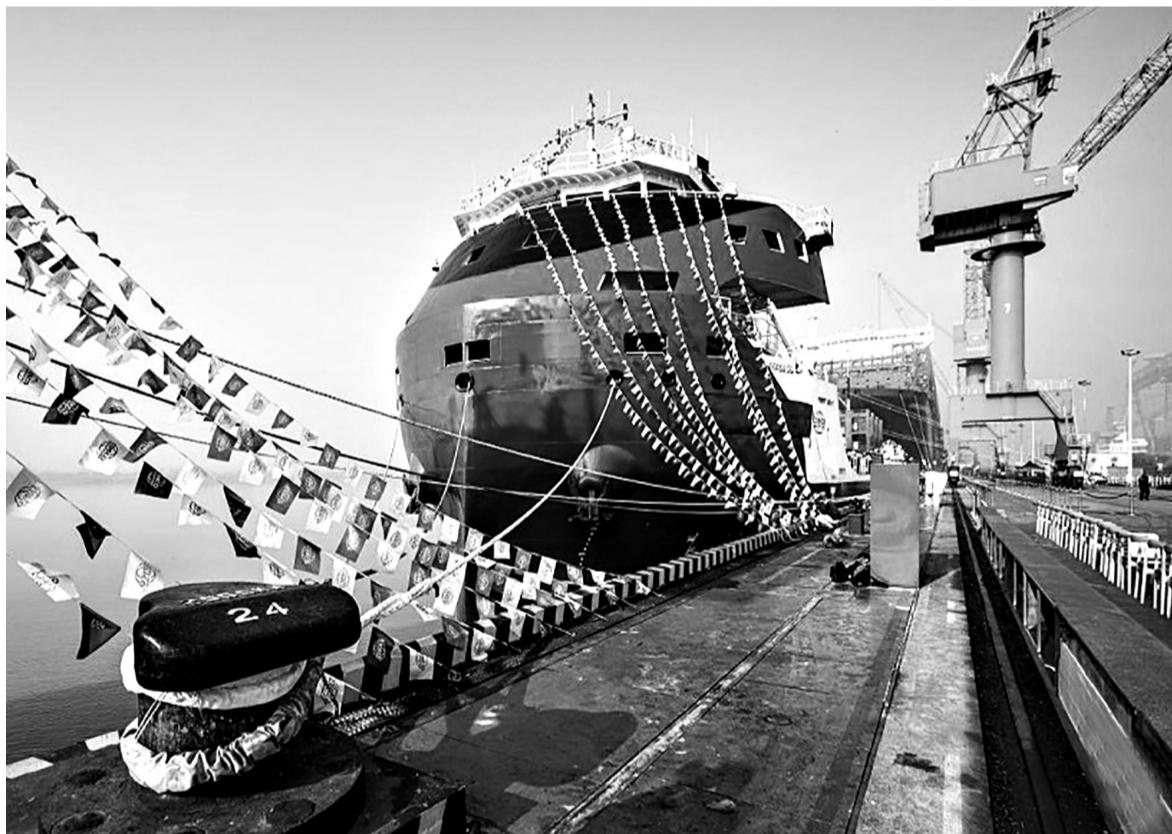
2023年12月28日,国产万吨级电动集装箱船“中远海运绿水01”“中远海运绿水02”正式命名交付,将于近期开启首航。“中远海运绿水01”“中远海运绿水02”为同型船只,由扬州中远海运重工有限公司自主设计制造。该型船长119.8米,宽23.6米,可装载700个国际标准集装箱。扬州中远海运重工有限公司联合当地供电部门设计的“以换代充”模式缩短了充电时间,有效提高了运输效率。图为当日拍摄的国产万吨级电动集装箱船“中远海运绿水01”。
