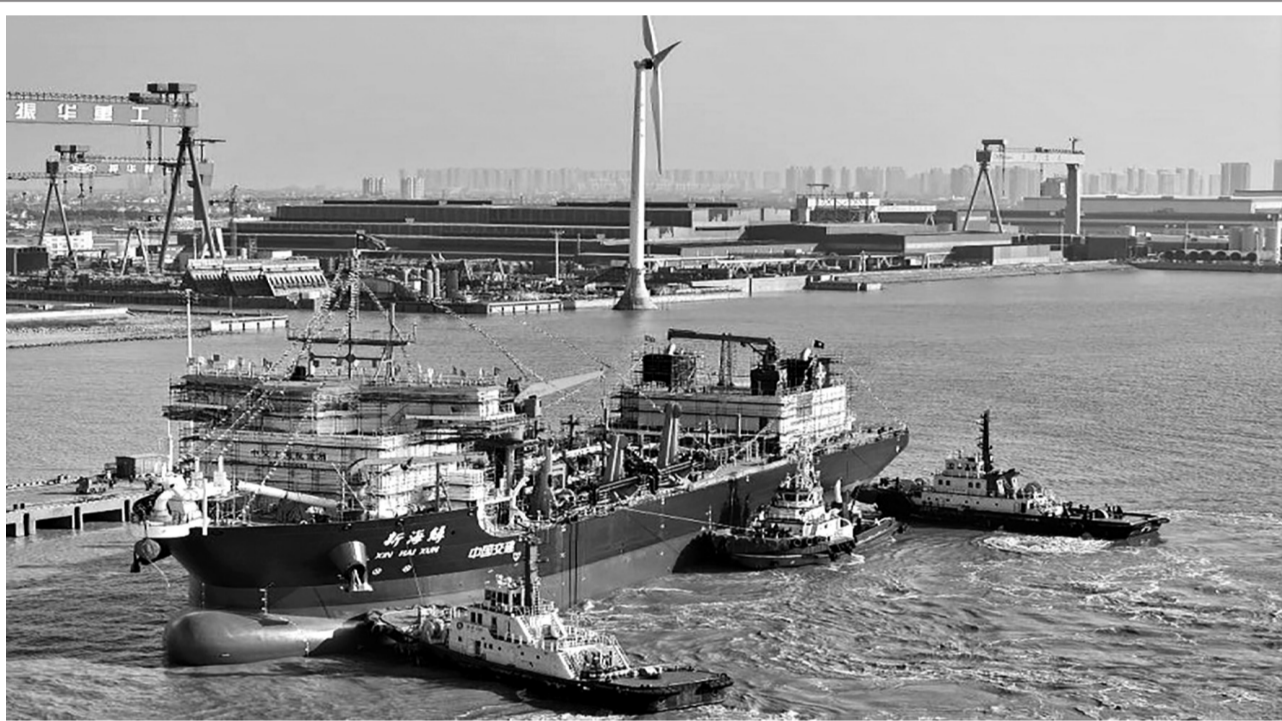
2023年12月24日,由中交上航局投资、振华重工建造的国内首艘1.5万立方米舱容双燃料动力耙吸挖泥船“新海蟹”号在江苏启东正式下水。
