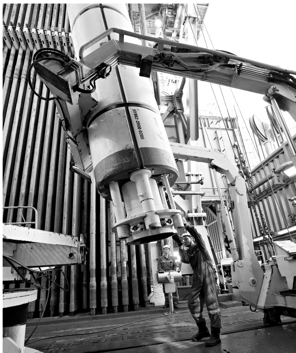
“海洋石油982”半潜式钻井平台是我国自主投资、于2014年至2018年建设的第六代深水半潜式钻井平台，型长104.5米、型宽70.5米、型高37.55米，最大钻井深度9144米，是全球最先进的第六代钻井平台之一。作为主力钻井平台，它参与了我国首个自营超深水大气田“深海一号”一期工程的建设，目前又投入二期工程的建设工作。从2018年至今，它共完成49口井的钻井井工作业，探明“深海一号”二期工程天然气储量达500亿立方米。据介绍，二期工程投产后将使“深海一号”大气田总体的高峰年产量从30亿立方米增长到45亿立方米。图为工人们在“海洋石油982”半潜式钻井平台上准备安装隔水管。
