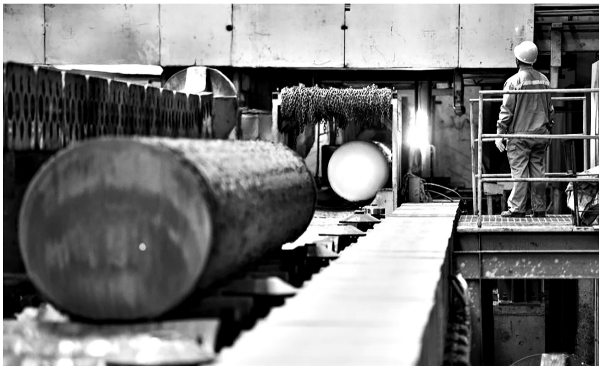
近期,1300毫米组距连铸圆坯生产线在河北省承德市营子区的大型特殊钢生产企业实现量产。大口径圆坯产品主要应用于大型海洋风电法兰、轴承和大型格石油油服阀体等用钢领域,1300毫米组距连铸圆坯的量产将逐步改写大厚壁法兰采用钢板锻造的历史,为我国能源领域大型装备的生产提供重要支撑。图为11月4日在承德市营子区一家特殊钢生产企业,工人查看切割后圆坯断面情况。 新华社发(王立群/摄)
