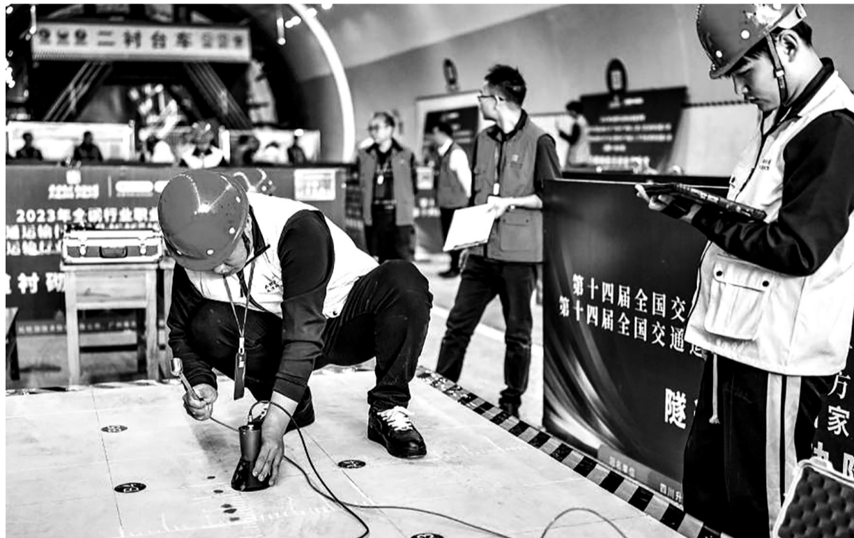
11 月 1 日,全国交通运输行业桥隧职业技能大赛总决赛在贵阳开赛,来自国内的 85 支队伍 214 名选手围绕钢筋骨架加工、隧道衬砌缺陷无损检测、施工放样等赛项展开角逐。比赛为期 4 天,设置职工组和学生组两个组别。图为当日选手参加隧道衬砌缺陷无损检测项目比赛。新华社记者 陶亮/摄
