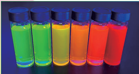
不同尺寸 CdSe (左，小→大，右) 量子点胶体溶液
