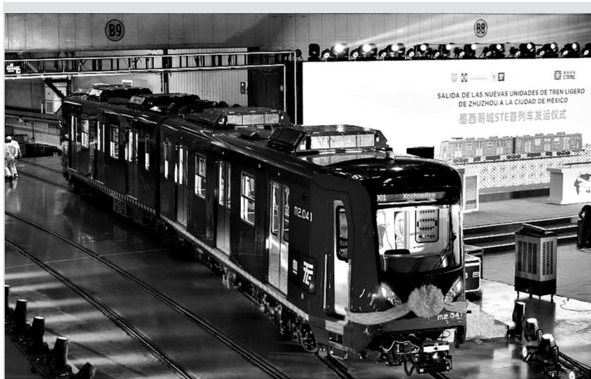
9月9日晚,中国中车为墨西哥首都墨西哥城定制的铰接式轻轨列车首列车在中车株机公司下线。该项目是采用完全自主知识产权的铰接式转向架的轻轨列车,列车设计时速80公里,长29.56米,宽2.65米,具有编组灵活、安全舒适等特点。这是在中车株机公司拍摄的“中国中车出口墨西哥城轻轨列车首列车(9月10日摄,无人机照片)”。新华社记者 陈泽国/摄
