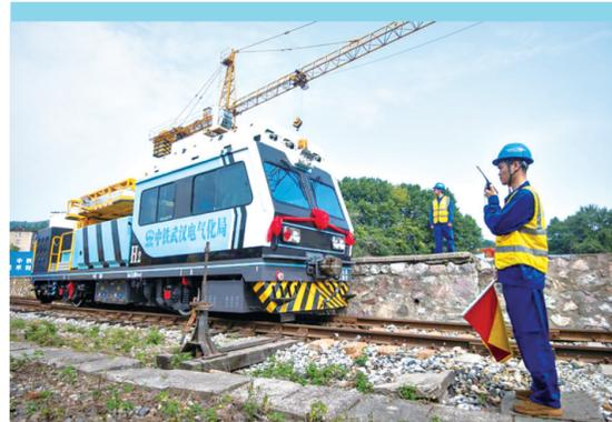
近日,由中铁武汉电气化局研制的氢能地铁施工作业车在湖北襄阳下线。据了解,该作业车采用氢燃料电池与锂电池混合动力系统提供牵引动力,设计时速80公里。这款作业车具有最大容量50公斤的储供氢系统,加注30分钟氢气,即可实现单机连续运行32小时,运行时没有废气和噪音,排放物为水,能应用于地铁、隧道、矿山等相对密闭的环境。图为工作人员在为下线的氢能地铁施工作业车运行做安全防护。
