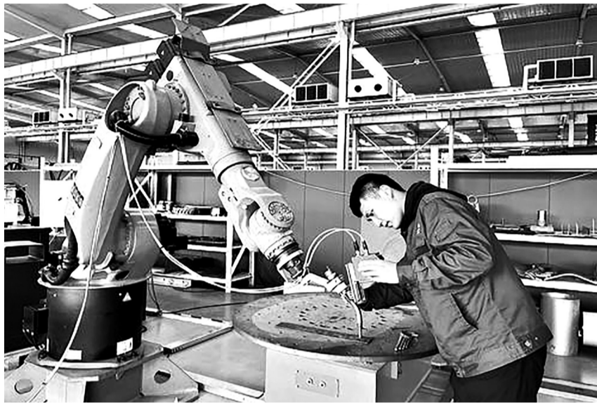
唐山英莱科技有限公司工作人员对焊接机器人前端传感器进行智能识别焊缝测试。 师源/摄
