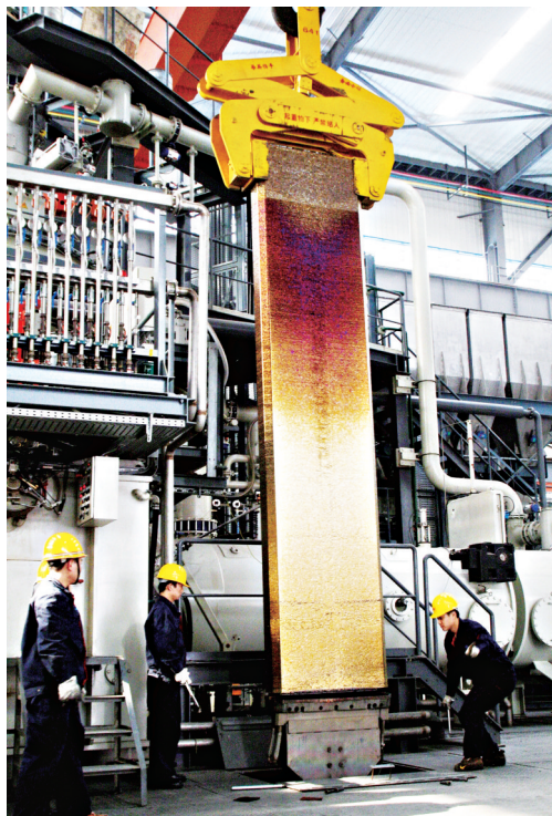
宝钛集团具有世界先进水平的2400kW冷炉床生产的钛扁锭
