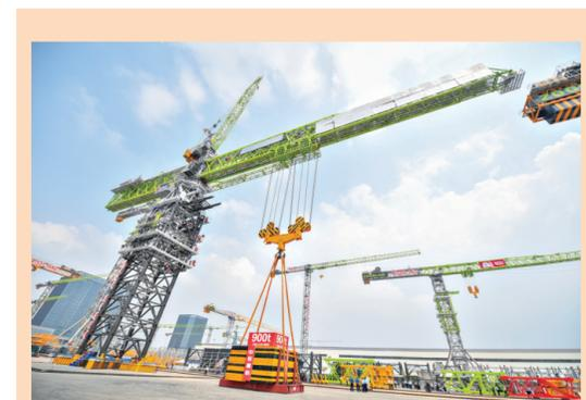
4月20日,中联重科R20000—720塔式起重机在位于湖南省常德市鼎城区的中联重科建筑起重工业园下线并交付。该起重机最大起重量720吨,最大起升高度400米,主要应用于重大工程建设领域。图为中联重科R20000—720塔式起重机。
