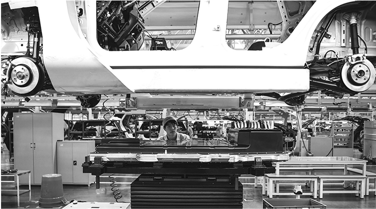
四川省宜宾市三江新区凯翼汽车有限公司技术人员在生产线上安装新能源汽车的动力电池。
