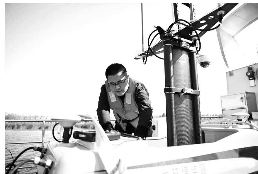
雄安新区生态环境局采用无人船采样,将水质数据通过5G信号回传,船上的水质监测设备能够实现快速分析,助力白洋淀区水质改善。图为工作人员在雄安新区白洋淀调试无人船。新华社记者 朱旭东/摄
