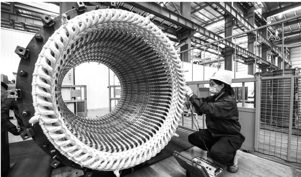
为应对全球新冠肺炎疫情,浙江省杭州市富阳区银湖街道联合税务、交通运输等相关部门对辖区内出口企业加强走访服务,帮助企业纾解困难,保障企业正常生产,同时对重点企业物流等问题进行精准帮扶和个性化支持,确保企业出口通道顺畅,提振行业信心。图为杭州新恒力电机制造有限公司车间内,工人在对电机进行耐压试验。
