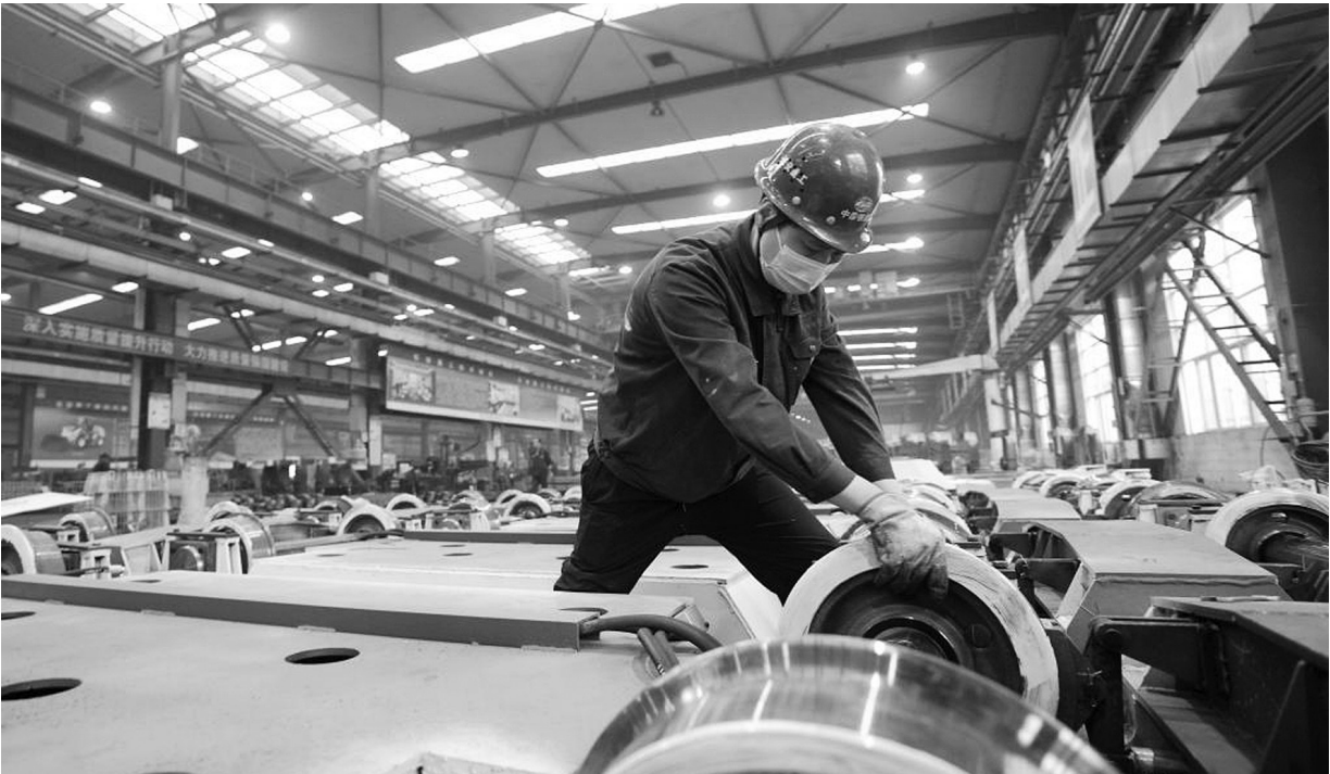
近期,随着各地轨道交通建设所需工程设备订单增加,中铁长安重工有限公司自行研制的电机车组、电动装载机等新能​​源工程设备迎来产销旺季。图为在中铁长安重工有限公司,工人检查新能源电机车的轮组。
