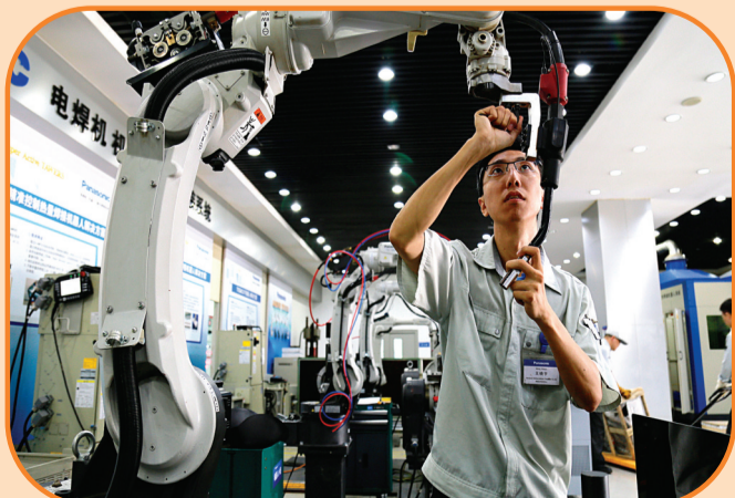
技术人员在唐山松下焊接技术应用中心调试机器人焊接设备
