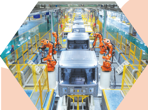
徐工汽车机器人焊接
