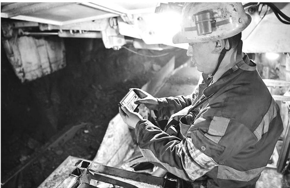
在陕西陕煤榆林北煤业有限公司下属的曹家滩智慧矿山,井下工作面的负责人只需在手机上操作,就可以控制煤机、液压支架、运输系统等工作面的大型设备。图为综采二队机电副队长蔡进通过操作手机控制生产设备。
