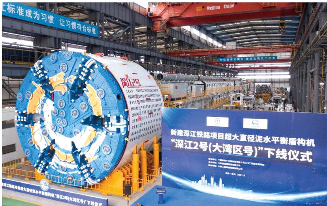
近日,应用于我国最深水下隧道——深(圳)江(门)铁路珠江口隧道工程的“大湾区号”盾构机在广东顺德下线。“大湾区号”是深江铁路珠江口隧道量身打造的超大直径盾构机,开挖直径达到13.32米,总长133米,总重约3900吨。同时,结合工程地质特点,针对性配备了小刀间距常压复合刀盘、超高压压力自动补偿、气垫直排掘进系统等创新科技,为隧道安全高效施工提供了坚强保障。
