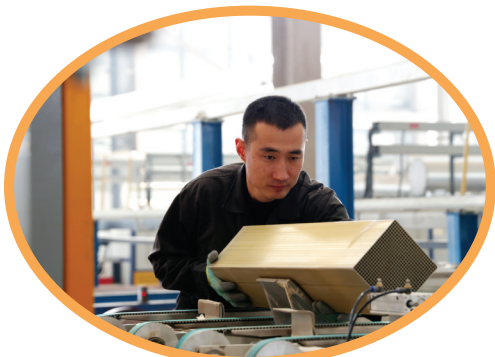
内蒙古希捷环保有限责任公司生产的稀土基烟气脱硝蜂窝状催化剂
