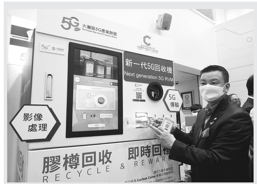
近日在香港举行的“5G新世代应用展”揭幕仪式上,“大湾区5G产业联盟”展出了一款智能塑料瓶回收机。该回收机通过5G技术,可辨认出塑料瓶的形状,进行自动分类,方便回收处理。
