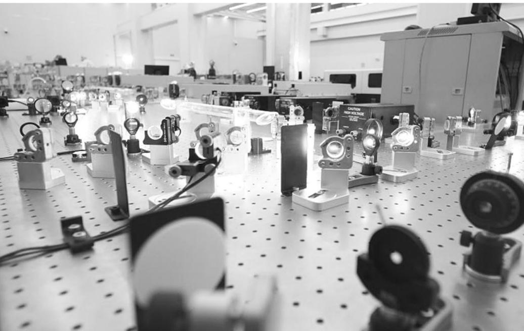
近日从中科院上海光机所获悉,上海超强超短激光实验装置已于近期逐步向用户开放,其输出功率高达10拍瓦,即1亿亿瓦,脉冲压缩后宽度达到飞秒量级,相当于10个太阳辐射到地球的总功率汇聚到一根头发丝上,由此得名“羲和”——传说中“十个太阳的母亲”。图为正在工作的“羲和”装置。
