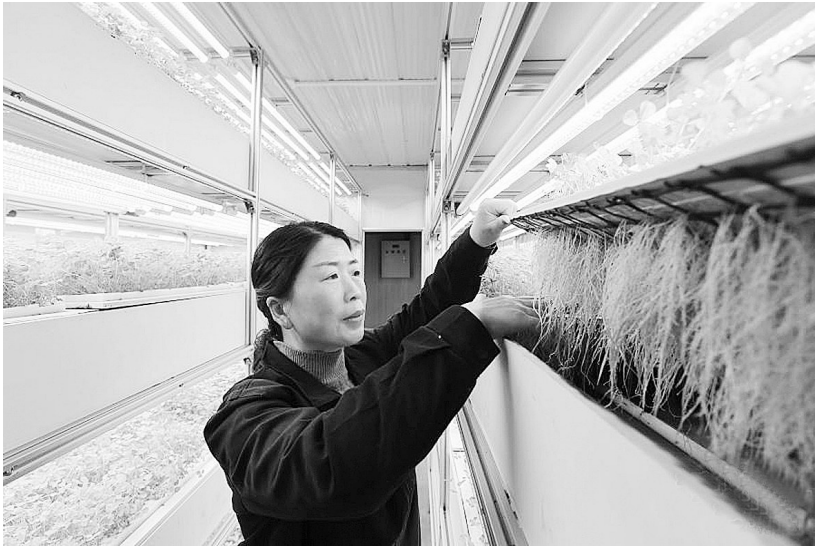
近年来,安徽淮北烈山经济开发区的农业科技企业研发制造可实现对植物所需光照、水分和养分进行智能化控制的“气雾栽培集装箱”,供应各地农户、合作社和农业企业。气雾栽培是一种新型的无土栽培方式,利用喷雾装置将营养液雾化成为小雾滴状直接喷射到植物根系,以提供植物生长所需的水分、养分。图为2月2日,在安徽省淮北市烈山经开区一家农业装备科技企业,工人在“气雾栽培集装箱”查看植物生长情况。
