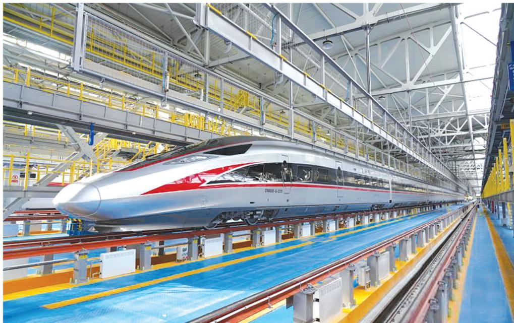
2021年1月6日,我国新型时速350公里复兴号高寒动车组首次在中国铁路北京局集团有限公司北京动车段朝阳动车运用所亮相。该动车组采用了铬铜合金钢螺栓螺母、自动化防冻功能制动、覆盖防寒材料的供排水管等技术、设备,可适应零下40摄氏度的运行环境。
