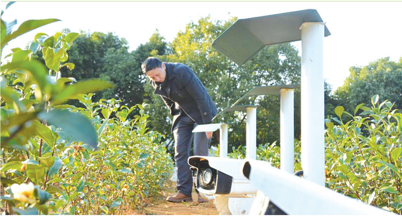
日前,由中国联通与福安农垦集团共同建设的5G农业智慧茶园正在各地平稳运行。采用5G农业智慧茶园,茶农刘生全明显感觉收获颇多。据悉,5G农业智慧茶园建有5G网络,可以让专家在远方通过电脑或手机指导农业生产;安装的摄像头可以24小时不间断监测,及时发现病虫害并自动报警及时除害;设置的传感器,可以实时监测土壤里的水、肥、温度等信息,让农户可以有针对性地配好水肥一体溶液等。应用科技手段后,每亩茶园可年增收300-500元,减少环境污染带来的社会效益更是难以估量。 新华社记者 林超/摄
