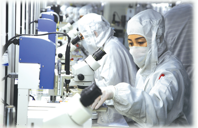
江馨微电机手机摄像头马达生产线
