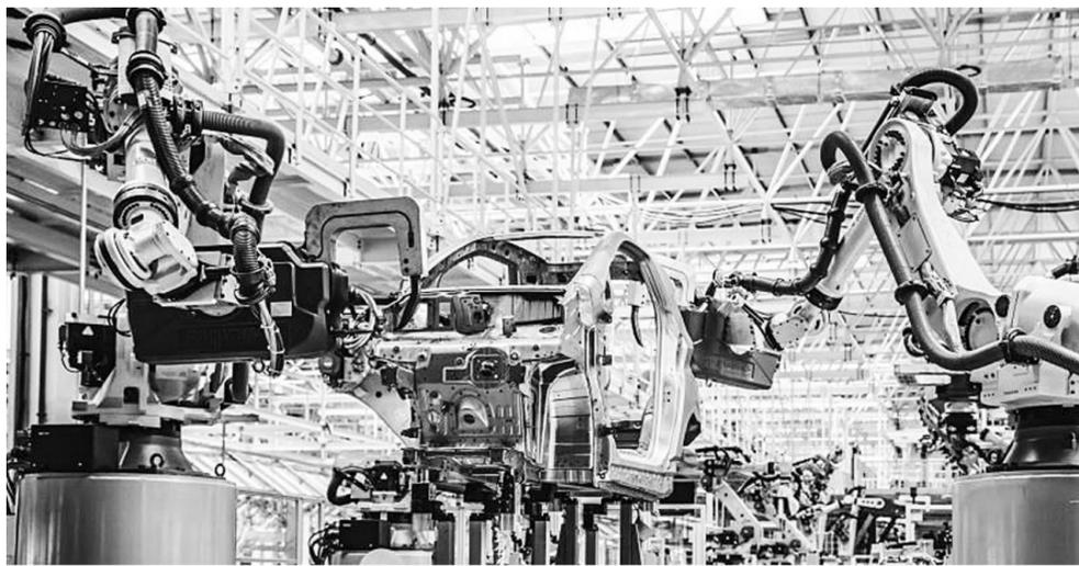
明珞装备焊装自动生产线
