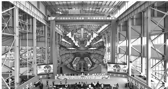
近日,一台最大开挖直径达16.07米的超大直径盾构机在中国铁建重工集团长沙第一产业园下线。这台盾构机整机长150米,总重量4300吨,是我国迄今研制的最大直径盾构机。 **新华社记者 戚晓毅 摄**
