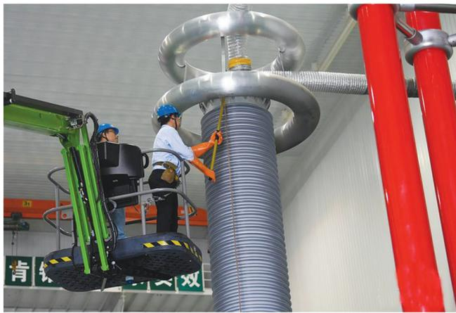
近日,国产535千伏直流电缆顺利通过试验,标志着我国自主生产的535千伏直流电缆材料具备投运条件,实现了535千伏电压等级直流电缆生产的全国产化。图为在国网舟山供电公司海洋输电工程技术实验室内,工作人员对完成试验后的国产535千伏直流电缆进行最后检测作业。新华社记者 徐昱/摄
