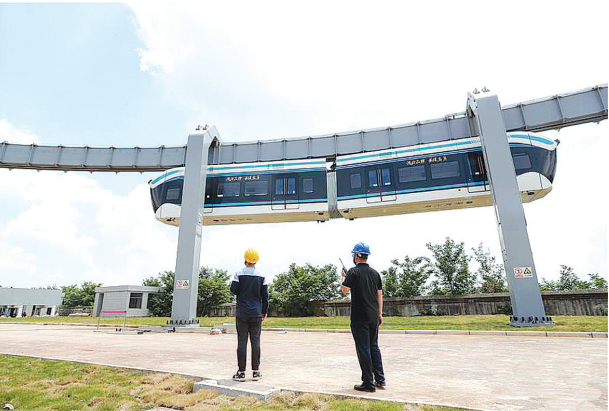
6月4日，空中轨道列车在武汉中铁科工集团江夏制造基地的试验线上试跑。据了解，“空轨”是悬挂式单轨列车，由钢铁或水泥立柱支撑在空中，列车最高时速80公里。
